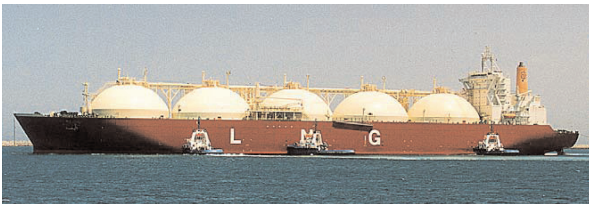
LNG carrier with Type-B tanks (Kvaerner Moss system).
